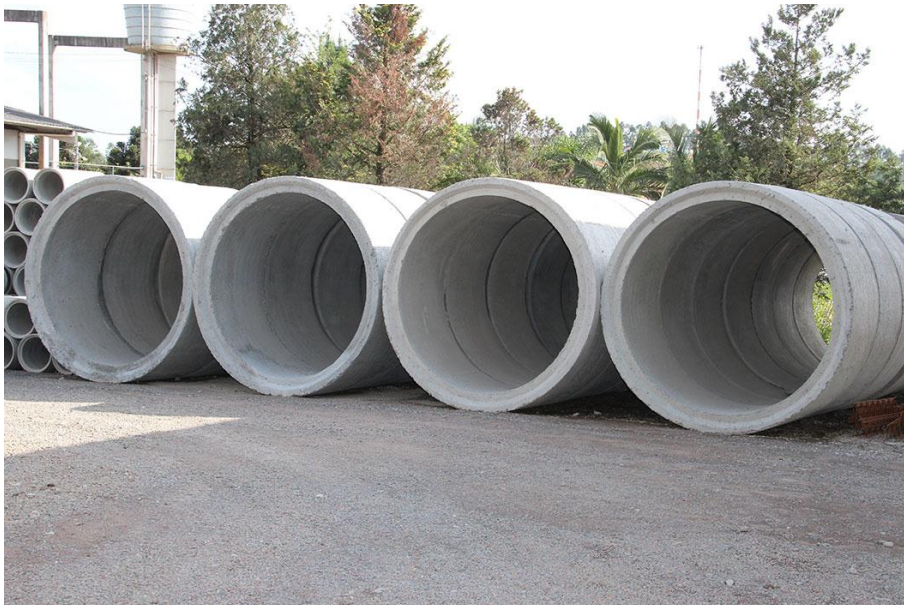
Foto 05: TUBOS DE CONCRETO ARMADO.
